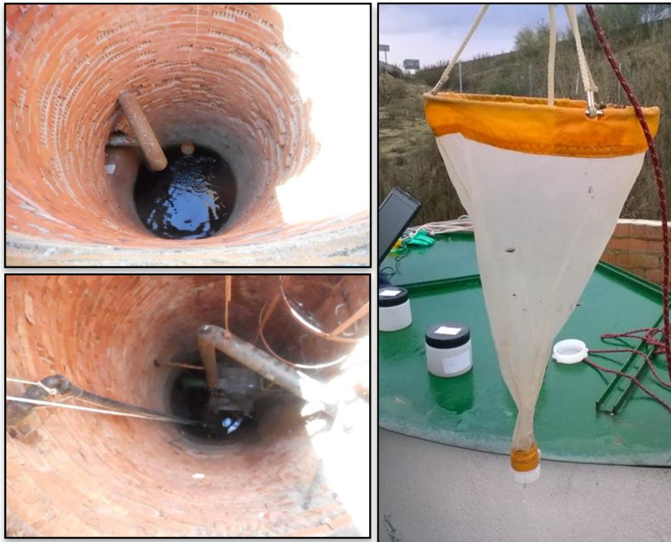
Figura 5. Izquierda: dos de los pozos usados como puntos de muestreo, puede observarse la bomba instalada (abajo) que dificulta el proceso de muestreo. Derecha: red de malla filtrante con tamaño de poro de 63 \mu\text{m} usada para el muestreo de fauna.
